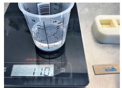
Fig. 3 : Mengbak, 50 gram A component met 60 gram B component (100 : 120).
